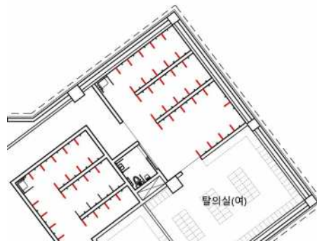
[그림 88] 샤워실 가림막 설치
