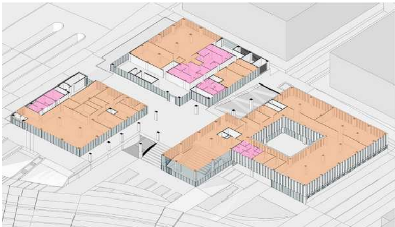
[그림 164] 지상2층 환기설비 계획도(합강동 복합커뮤니티센터)
