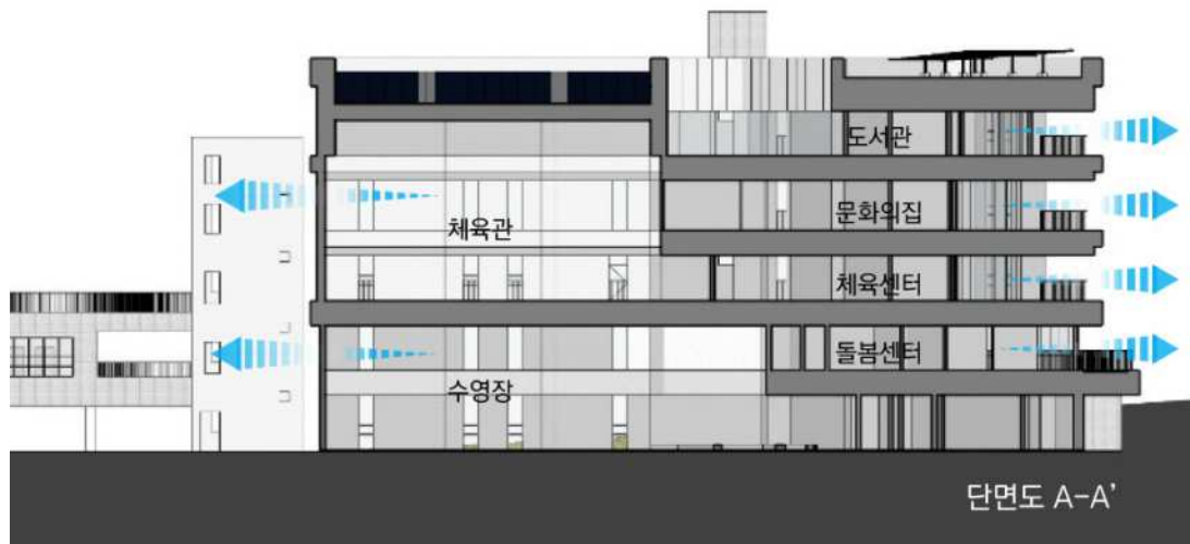
[그림 93] 외부 개폐창 설치에 따른 자연환기 계획 1
