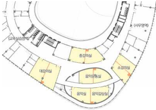
[그림 200] 3층 무빙월 설치 영역
